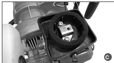
Рис. 11 Обслуживание воздушного фильтра
