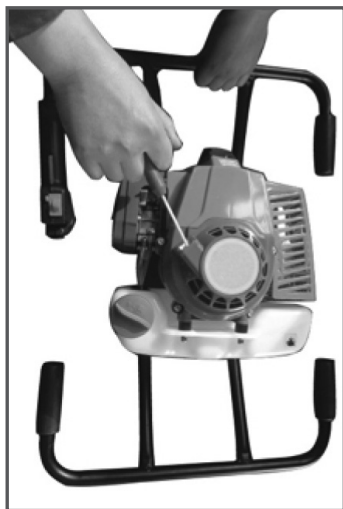
Рис. 7 Свободный ход шнура стартера
